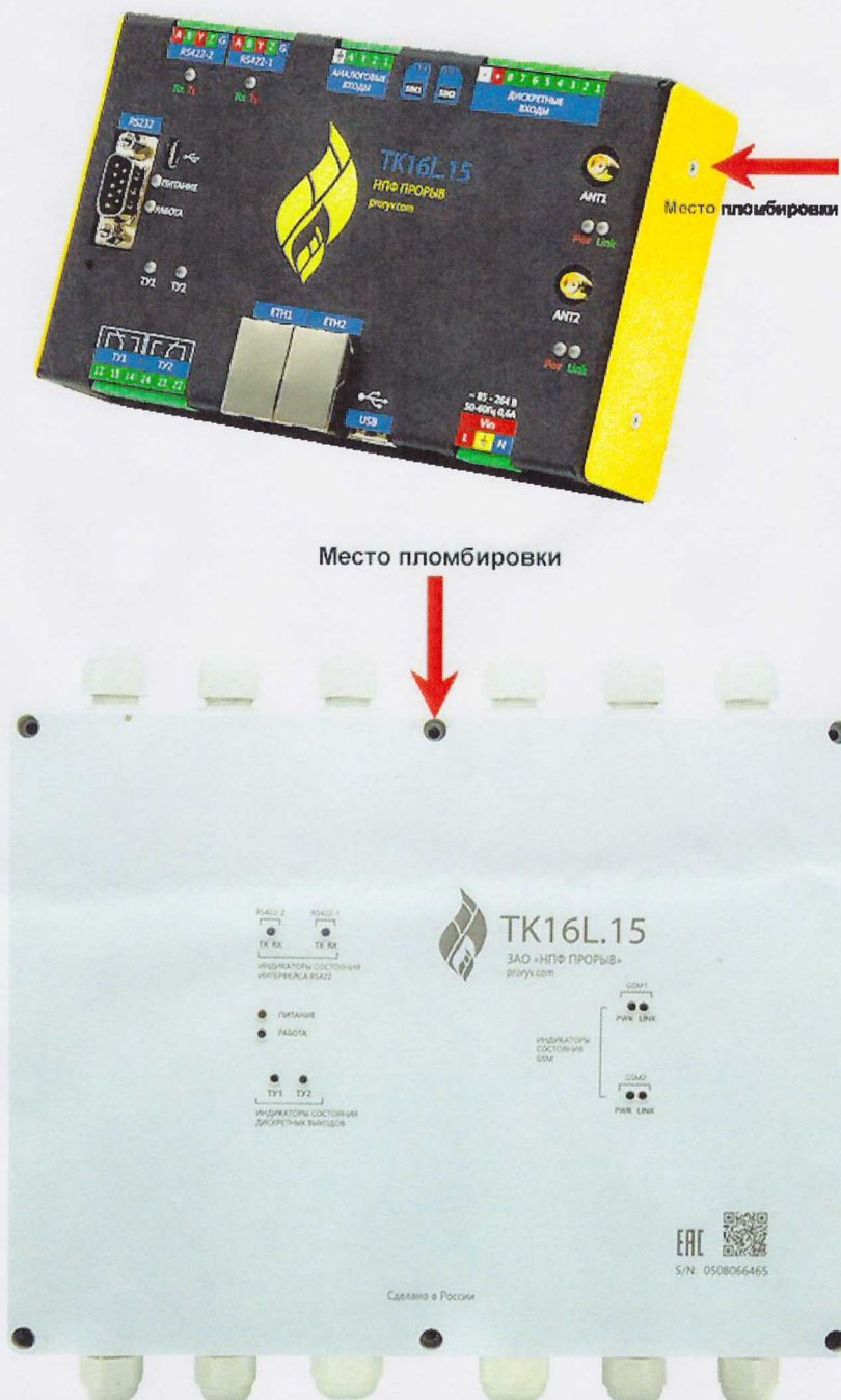
Рисунок 2 – Общий вид, места пломбирования УСПД с металлическим корпусом (вверху), с пластиковым корпусом (снизу)
